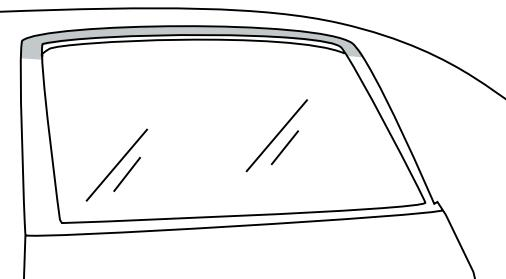
Retirer la protection d'adhésif des rebords avant et arrière. Décoller environ 5 cm (2 po) de protection d'adhésif à chaque extrémité.
